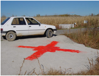
Figura 1: Ejemplo de dianas terreno para puntos de control marcados en campo previo a la toma.
