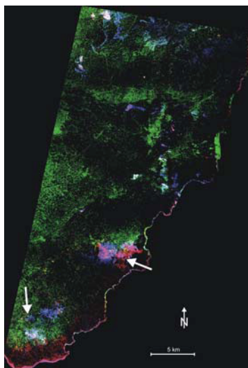
Figura 3: Imagen RGB de las CP4 correspondientes a abundancia relativa de caolinita (R), illita (G) y caolinita+esmectita (B). Las flechas indican nuevos núcleos de alteración no detectados con datos TM.
